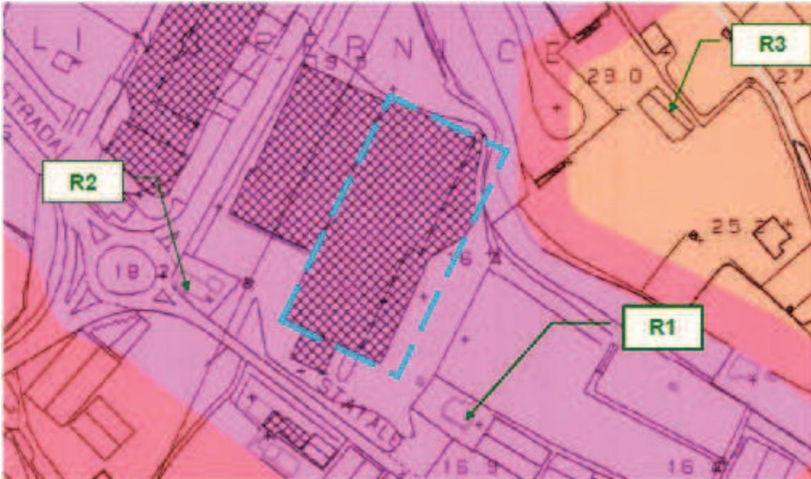
L'elaborato grafico seguente riporta l'ubicazione dello stabilimento e delle aree ad esso pertinenti. L'elaborato grafico contiene altresì l'indicazione delle posizioni ove sono stati condotti i rilievi fonometrici relativi al rumore residuo e la posizione dei principali punti di ricezione ossia le civili abitazioni presenti nella zona circostante il complesso IPPC.
