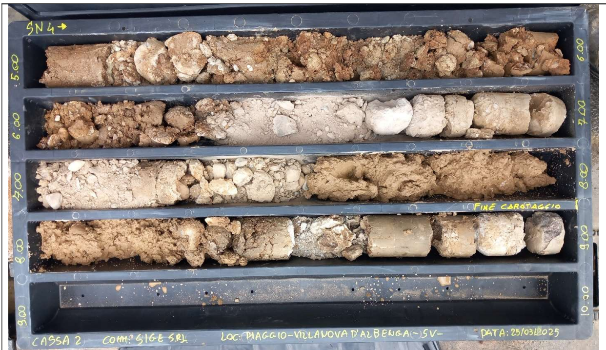
Sondaggio SN4 - Cassetta catalogatrice 5-10
